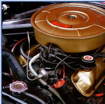
Die Mustang-Motoren gelten als thermisch anfällig. Im Bild: ein früherer 260-cui-V8
