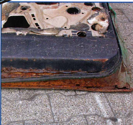
Die Unterseiten der Türen gammeln, wenn die Abflöcher verstopft sind – was die Regel ist
