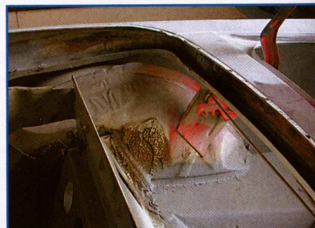
Bei Cabrios ist auf den Verdeckkasten zu achten, vor allem auf die untere Wasserablaufeiste
