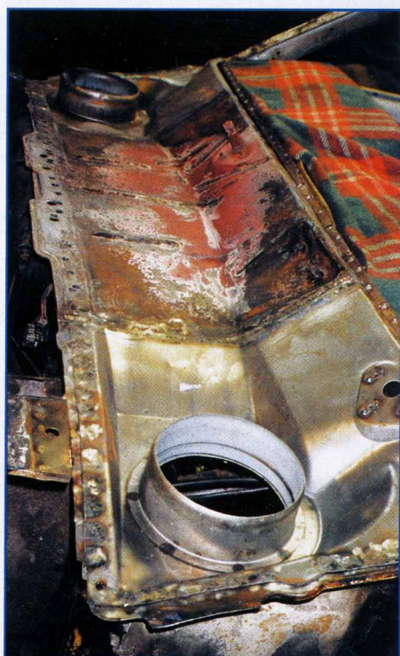
...Schweißpunkte ausgebohrt werden, damit fachgerecht repariert werden kann
